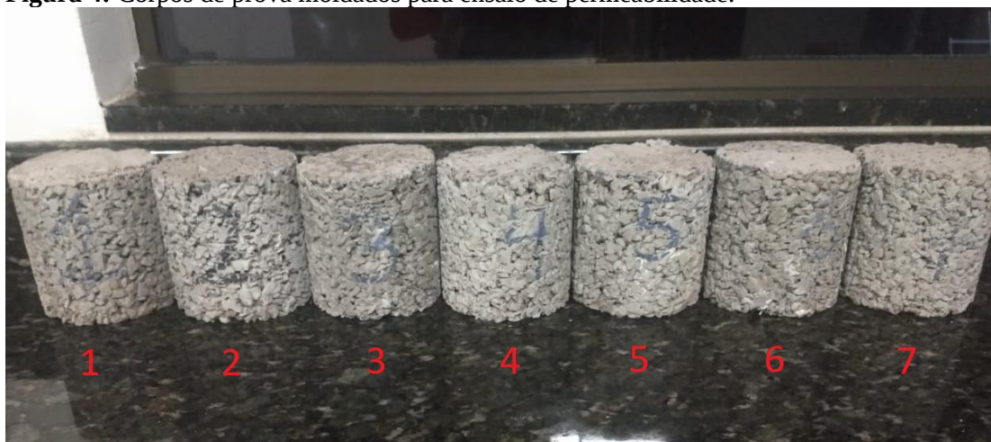
Figura 4: Corpos de prova moldados para ensaio de permeabilidade.
