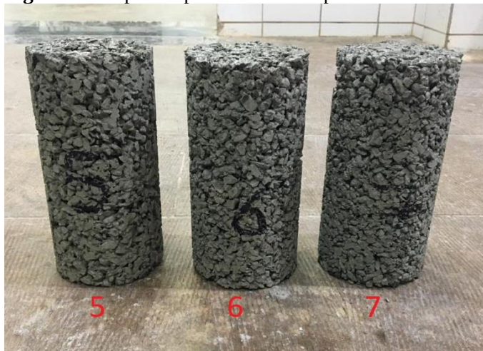
Figura 3: Corpos de prova moldados para ensaio de compressão numerados de 5 a 7.
