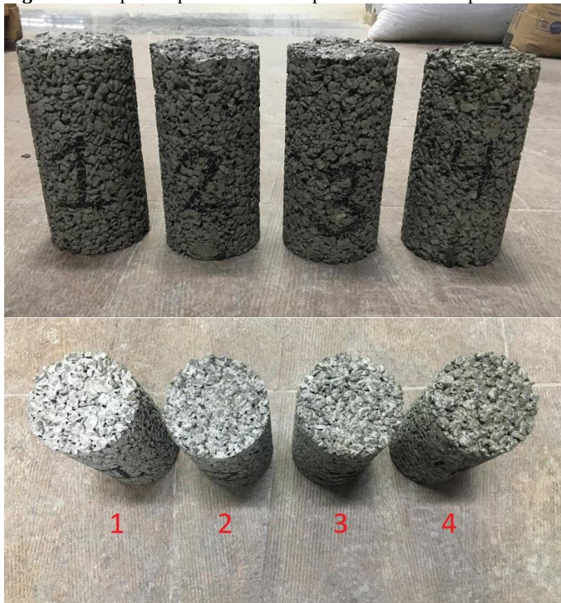
Figura 2: Corpos de prova moldados para ensaio de compressão numerados de 1 a 4.
