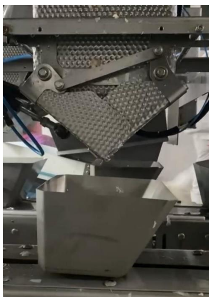
Figura 03 - Exemplo de transportador de canecos em aço inox para produtos in natura.
