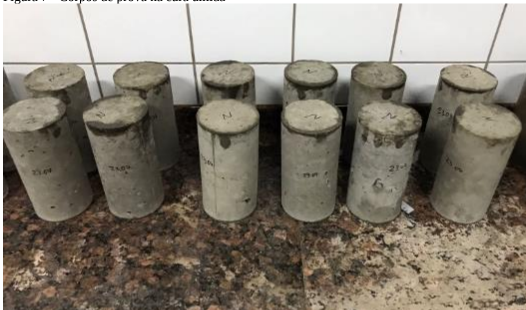
Figura 7 - Corpos de prova na cura úmida
