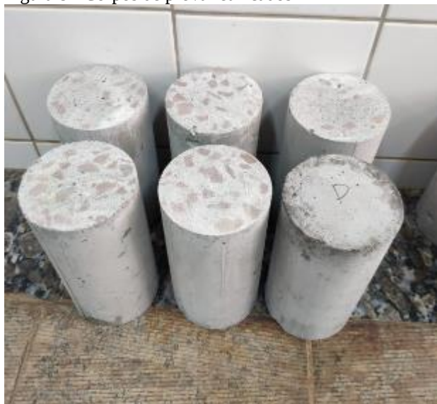
Figura 8 - Corpos de prova retificados
