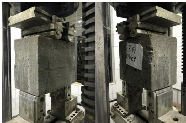
Figura 9 – Ruptura do corpo de prova com fibra de vidro após ensaio de tração na flexão sob temperatura ambiente
