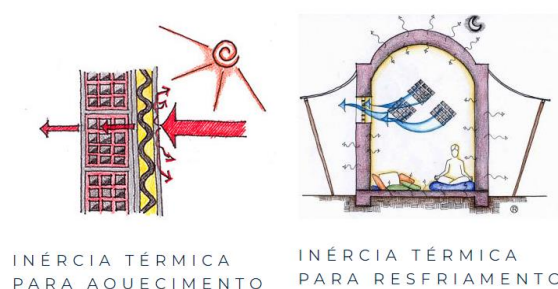
Figura 4 – Estratégias Bioclimáticas: Inércia Térmica
