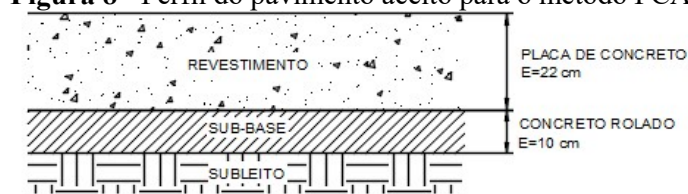
Figura 8 - Perfil do pavimento aceito para o método PCA - 1984
