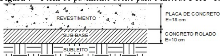
Figura 7 – Perfil do pavimento aceito para o método PCA - 1966
