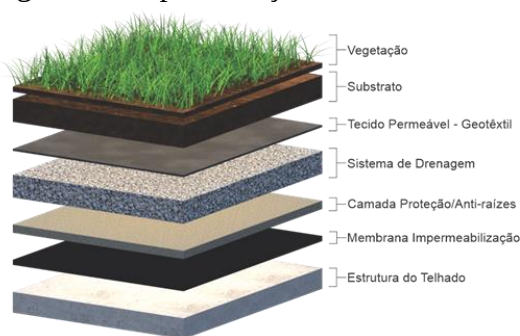
Figura 5 - Representação das Camadas de m Telhado Verde.
