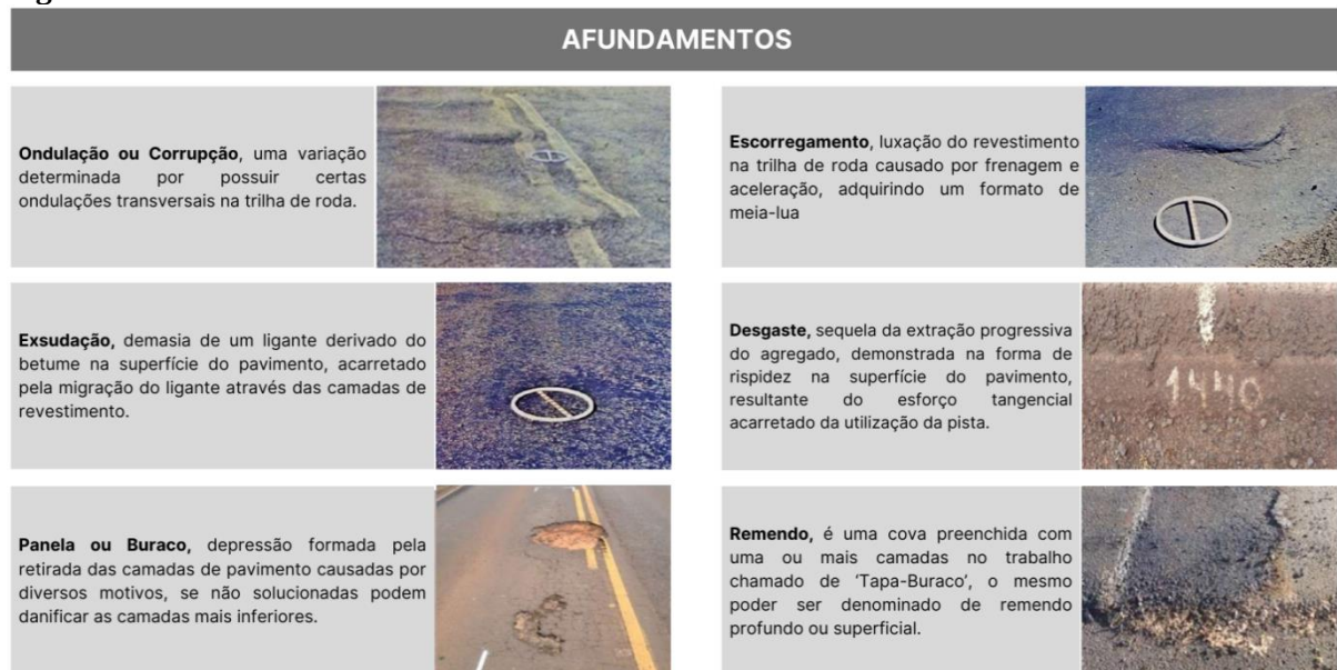
Figura 4: Diferentes características de afundamentos.
