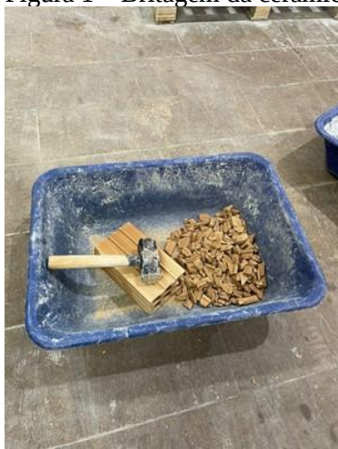
Figura 1 – Britagem da cerâmica
