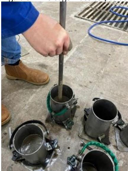
Figura 3 – Moldagem dos corpos de prova
