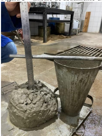
Figura 5 – Ensaio de abatimento do tronco de cone
