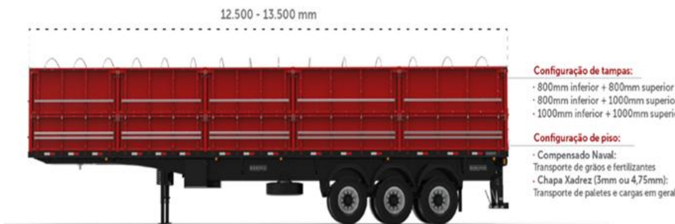
Figura 2 - Graneleiro Com Especificações Técnicas
