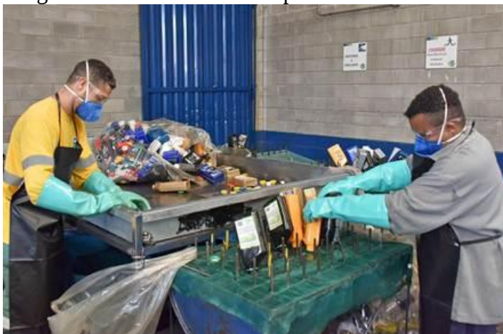
Imagem 08: Colaboradores no processo da retirada de excessos de óleo lubrificante.
