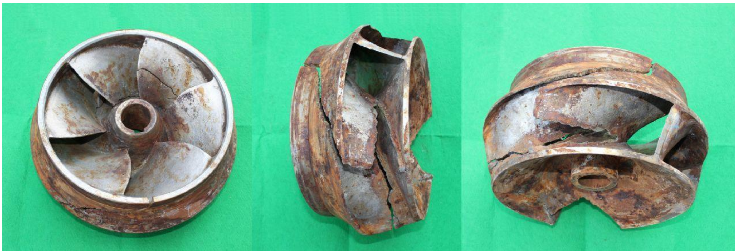
Figura 02 - Erosão causada pela cavitação em lâminas de bomba hidráulica.
