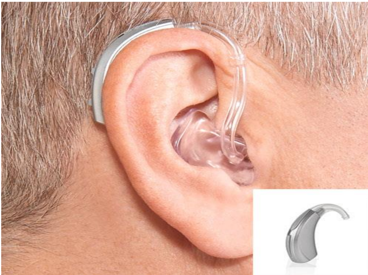
Figura 1 – Aparelho de Amplificação Sonora Individual (AASI)
